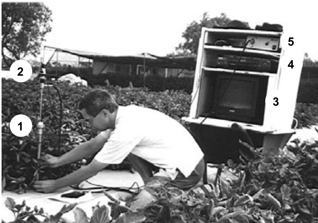
Abb. 2: Anwendung der Minirhizotron-Technik zur Erfassung von Tomatenwurzeln im Feld. 1: Endoskop mit Führungsrohr, 2: CCD-Kamera, 3: Monitor, 4: Videorekorder, 5: Kaltlichtquelle.
