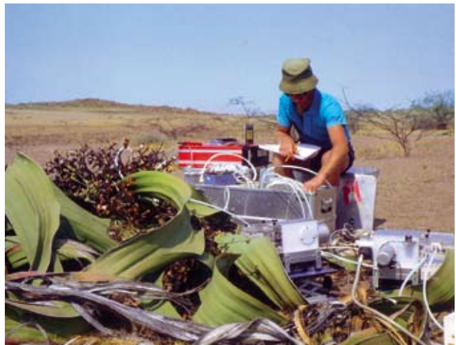
Abb. 2. Messung der Netto-Photosynthese und Transpiration mittels klimatisierter Gaswechsellkuvetten am Standort Brandberg-West.
