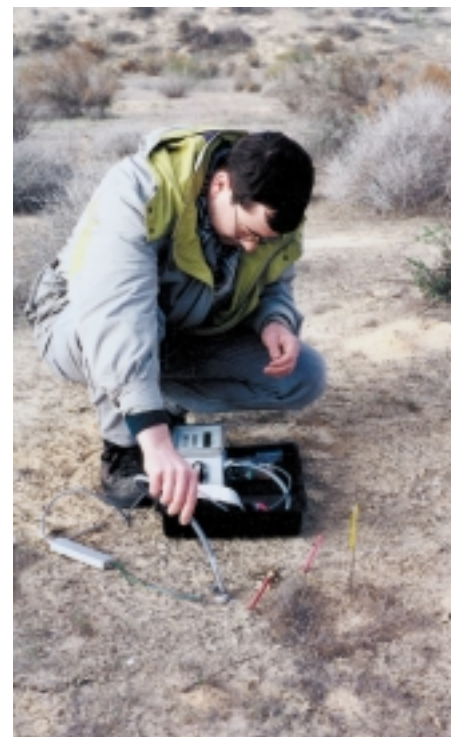
Abb. 6: Messung der Photosyntheseaktivität mit der Chlorophyllfluoreszenz-Technik nach nächtlichem Taufall.
