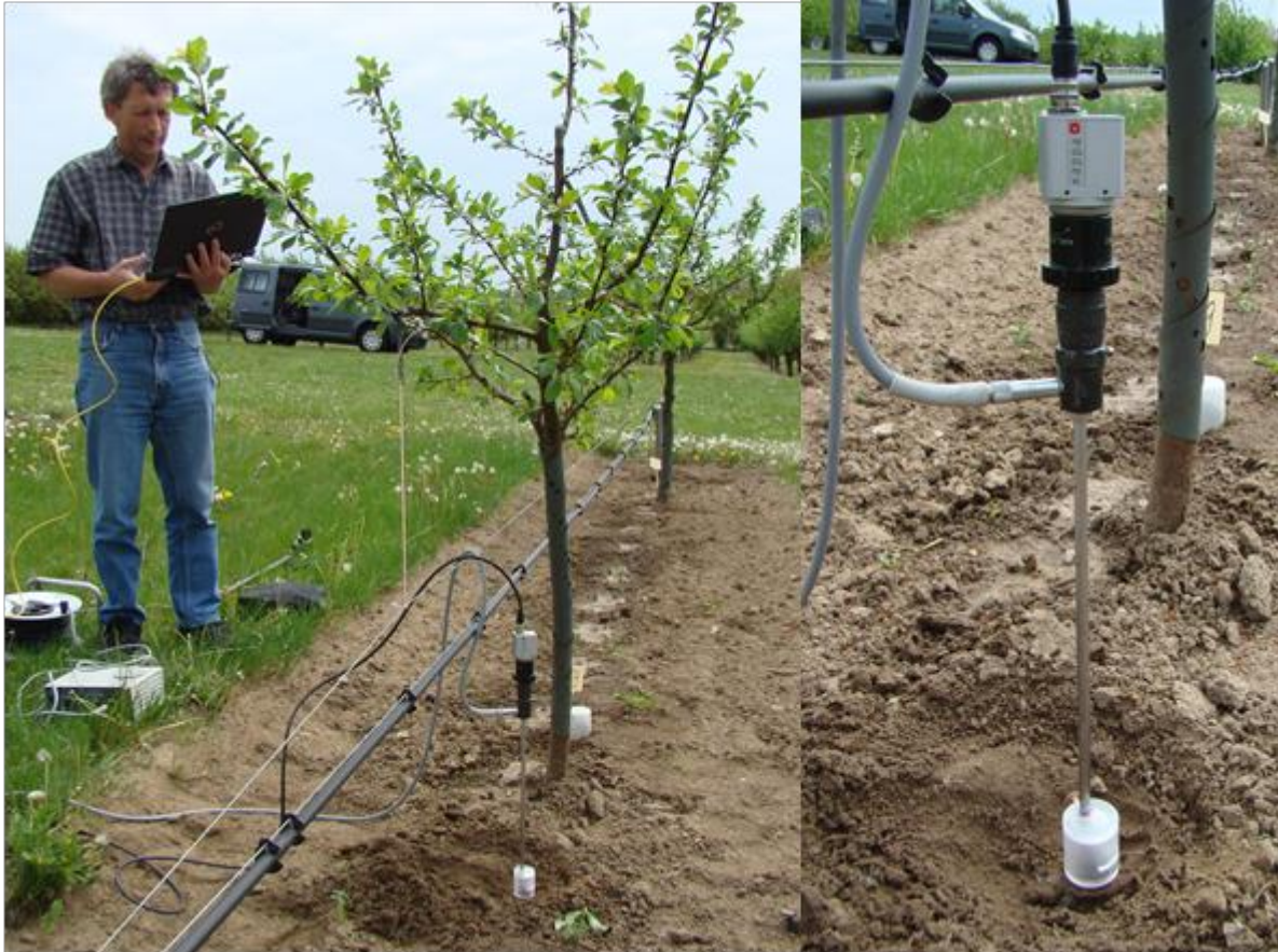
Bild 2: Anwendung von Minirhizotronen und der Endoskopie-Technik zur Untersuchung der Feinwurzelndynamik von Apfelbäumen am ATB Potsdam-Bornim
