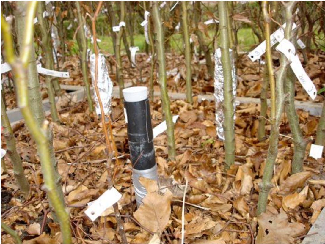
Bild 1: Installation der Glasröhren (Durchmesser 30 mm) für Minirhizotron-Untersuchungen mit einem starren Endoskope. Um das Eindringen von Licht in den Boden über die Glasröhren zu vermeiden, ist der obere Teil mit einem schwarzen Klebeband versehen
