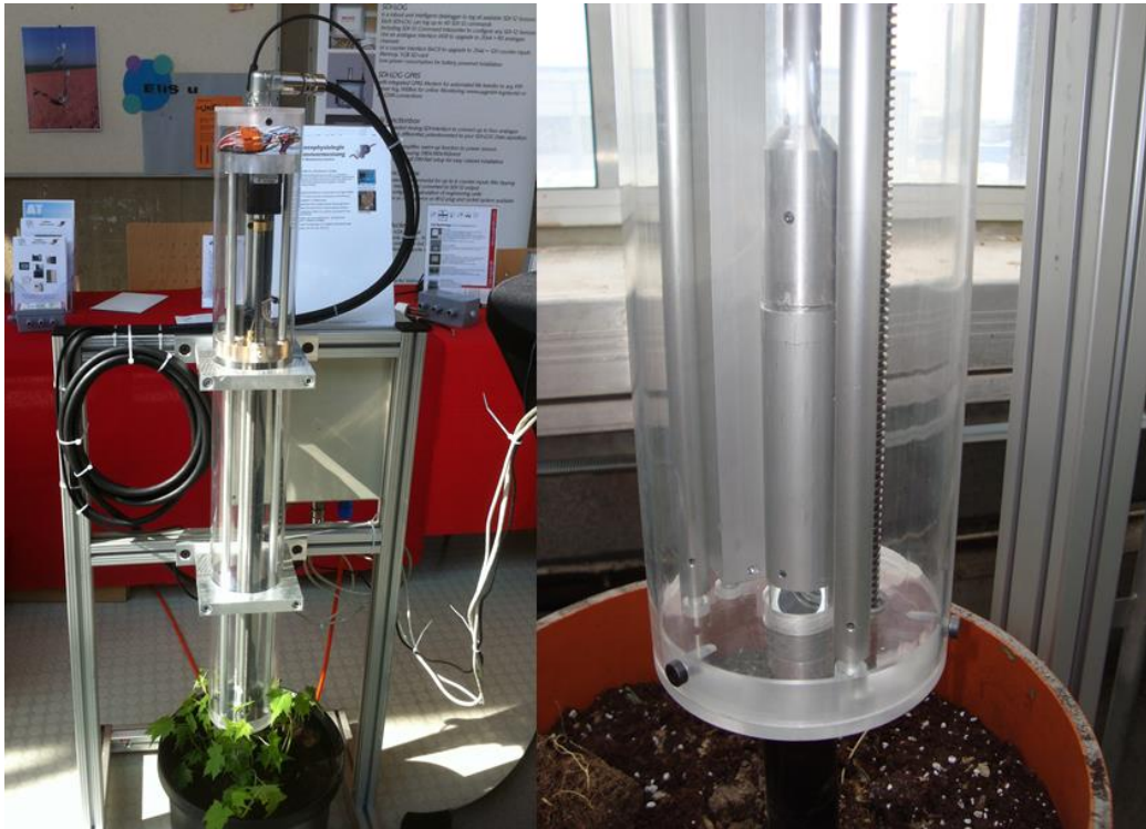
Bild 1: Automatisches Minirhizotronsystem mit automatischer Führung zur Untersuchung des Wurzelwachstums (A), Positionierung der Fingerkamera in den Minirhizotronröhren (B)
