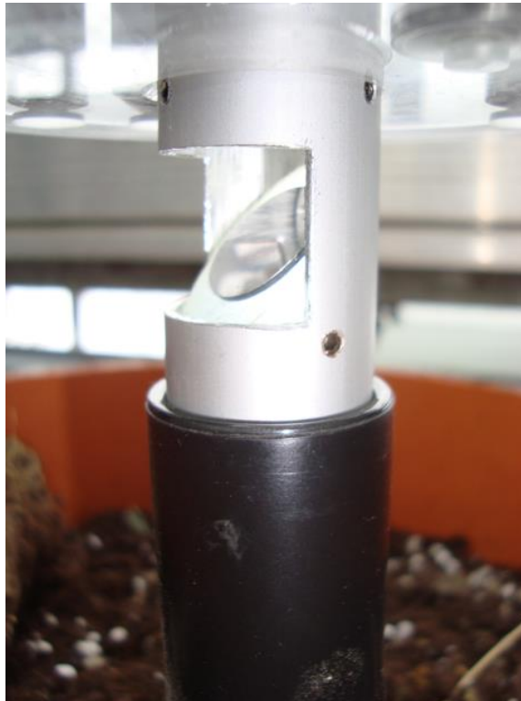
Bild 1: Schwarzweiss-Fingerkamera mit Spiegel und indirekter Beleuchtung zu Beobachtung von Wurzeln in Minirhizotronen.
