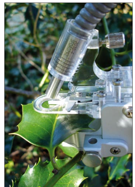
Abb. 2: Die Chlorophyllfluoreszenz-Technik erlaubt eine störungsfreie Messung der Photosynthese.
